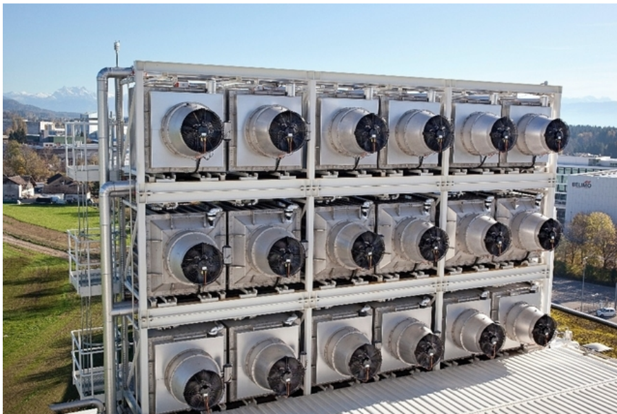
La société Climeworks se charge de l'extraction du CO2 de l'atmosphère (ici les aspirateurs) dans le cadre du projet du Karlsruhe Institute of Technology, qui vise sa conversion en noir de carbone.
